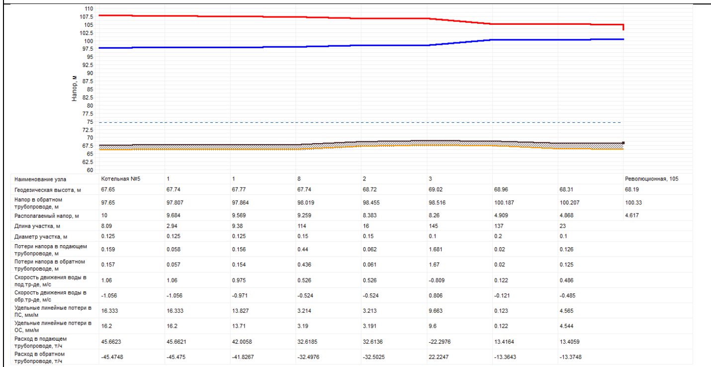
Рис.16 Пьезометрический график (Котельная №5 – ул. Революционная, 105)
