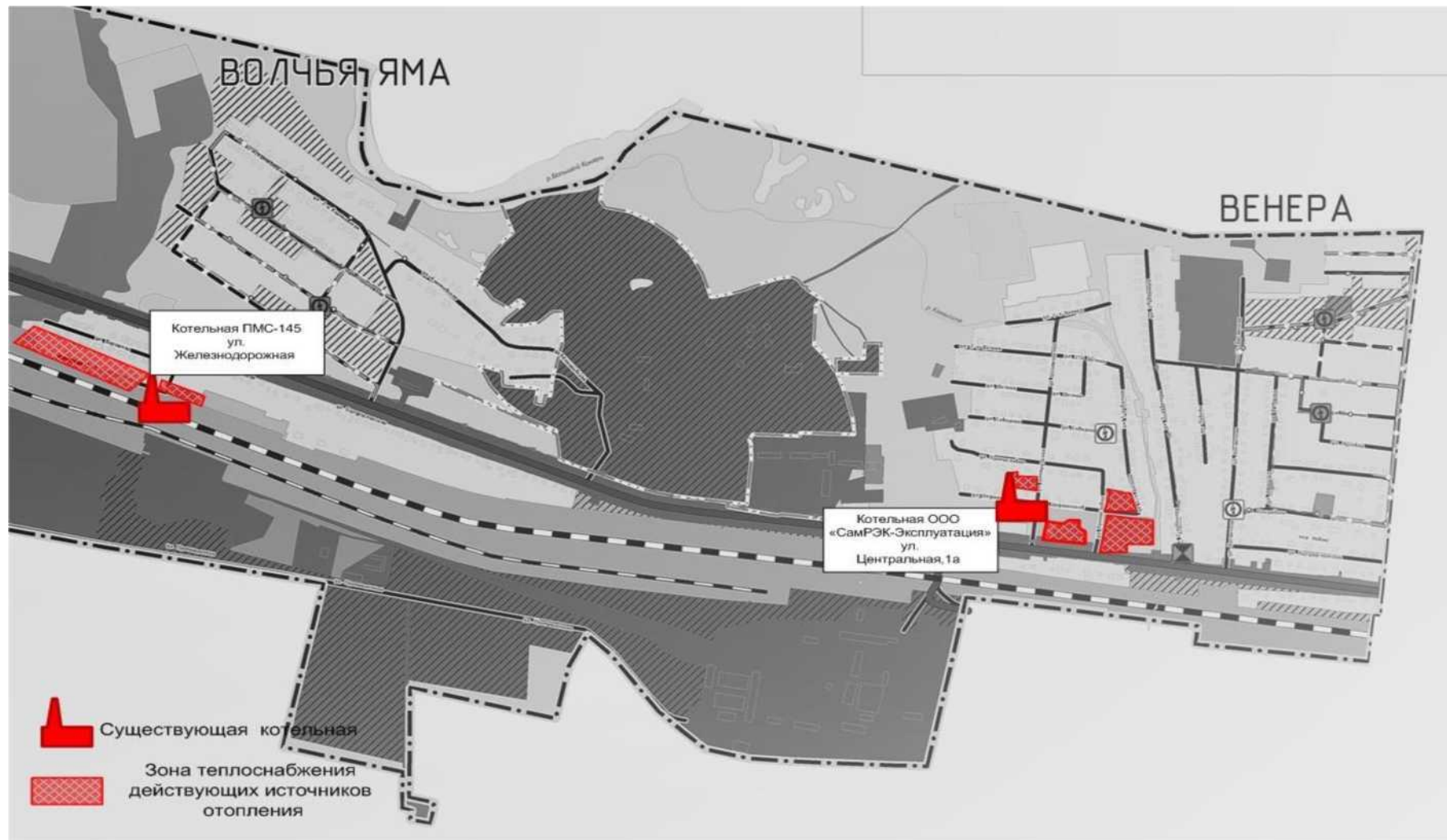
Рисунок 7 - Существующая зона централизованного отопления микрорайона Венера
